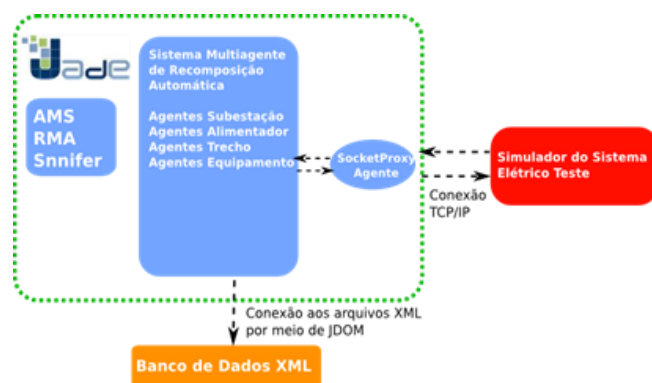
Figura 4. Arquitetura do SMRA integrada ao simulador de teste e validação
